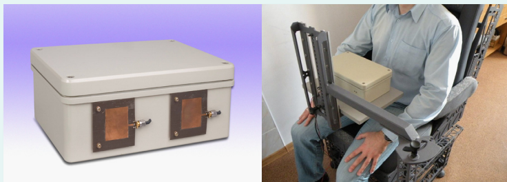
Widok ogólny sensora mikrofalowego oraz stanowiska pomiarowego
